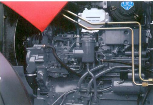
Die Wartungsintervalle des Motors, das heißt Motoröl- und Motorölfilterwechsel, sind mit 500 Betriebsstunden sehr weit gesteckt. Die anfallenden Betriebskosten reduzieren sich somit auf ein notwendiges Minimum. Erleichtert werden die Wartungsarbeiten durch die nach hinten klappbare Motorhaube, wodurch ein uneingeschränkter Zugang zu allen Motorkomponenten möglich wird. Kluge Details, wie eine seitliche Öffnungsklappe zur Wartung des Luftfilters, komplettieren das durchdachte Wartungskonzept.
