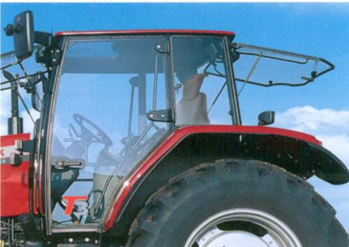
Die optional verfügbare Niedrigkabine ist besonders geeignet für Gebäude mit niedrigen Durchfahrthöhen. Diese ist ebenso komfortabel wie die Serienkabine und ist ebenso mit einer Klimaanlage ausgerüstet. Das Dachfenster verbessert deutlich die Übersicht bei Frontladerarbeiten.
