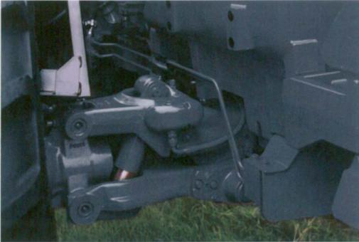
Sowohl die starre als auch die einzelradgefederte Vorderachse können wahlweise mit nassen Scheibenbremsen ausgerüstet werden. Dadurch wird eine integrale Bremswirkung auf alle vier Räder ohne automatische Zuschaltung des Allradantriebes möglich.
