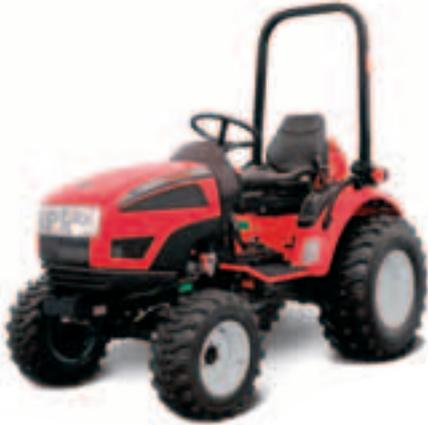
Der kleine McCormick X10.25 eignet sich aufgrund seiner Eigenschaften für leichte Feldarbeiten sowie für die Wartung von Grünanlagen. Dieses Modell wird von einem wassergekühlten 3-Zylinder-Dieselmotor mit 22 PS angetrieben, der die Abgasnorm Tier 3 erfüllt.
